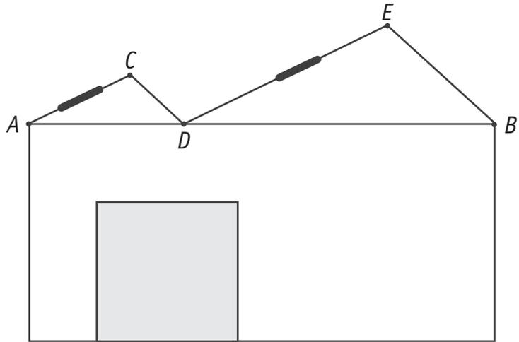
Pour installer des panneaux solaires, l'idéal est d'avoir une inclinaison du toit comprise entre  $30^\circ$  et  $35^\circ$ .
